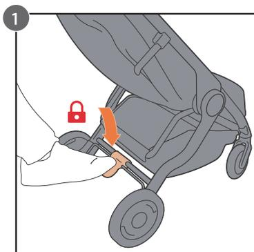
折りたたむ前にブレーキペダルを押し下げてロックをかける
